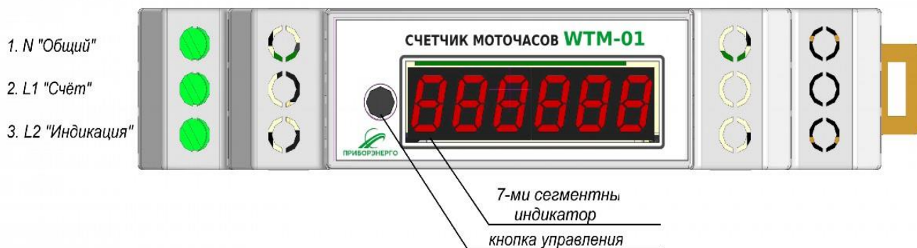
Рисунок 2 – Панель управления и индикации и назначение выводов счётчика моточасов WTM-01
