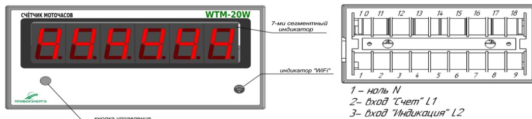
Рисунок 2 – Панель управления и индикации и назначение выводов счётчика моточасов WTM-20W
